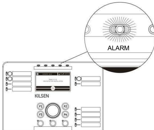
Ako zujalica zuji, a lampica „Greška“ konstantno svetli, onda se radi o grešci.
