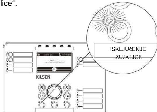
Lampica „Isključenje zujalice“ se pali, a zujalica isključuje. Novi alarmni događaji ili greške ponovo će uključiti zujalicu.
