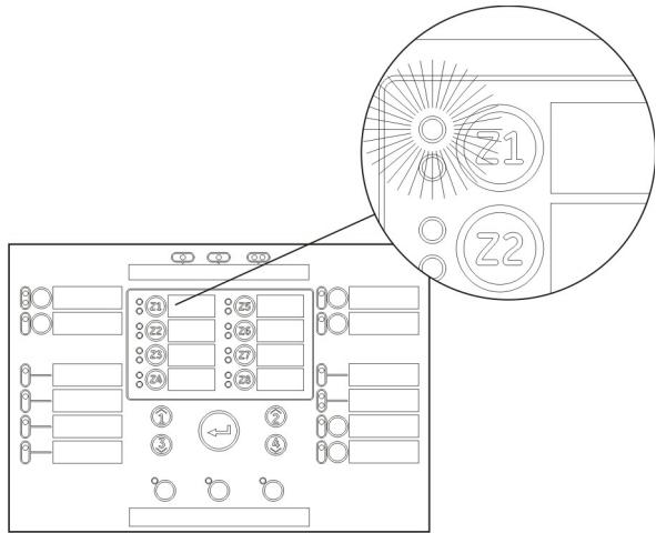
Ako LED dlampica požar (FIRE) i lampica zone trepte, požarni alarm je dojavljen sa automatskog detektora, ako svetle stabilno, alarm je sa ručnog javljača.
