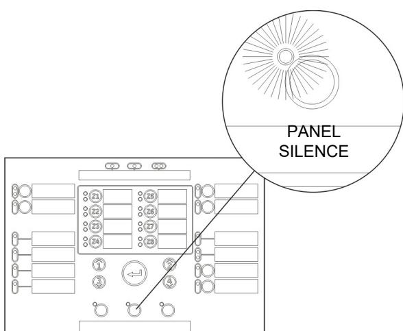
Nakon utišavanja zujalice pali se LED lampica iznad tastera.
