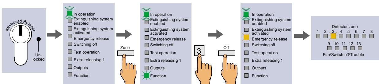
Lampica isključene zone svetli žuto. Tasterom "Switchover" se može birati između prikazivanja statusa zona odnosno statusa izvršnih funkcija na lamicama. Ako se tastatura isključi automatski se pokazuje status detektorskih zona.
